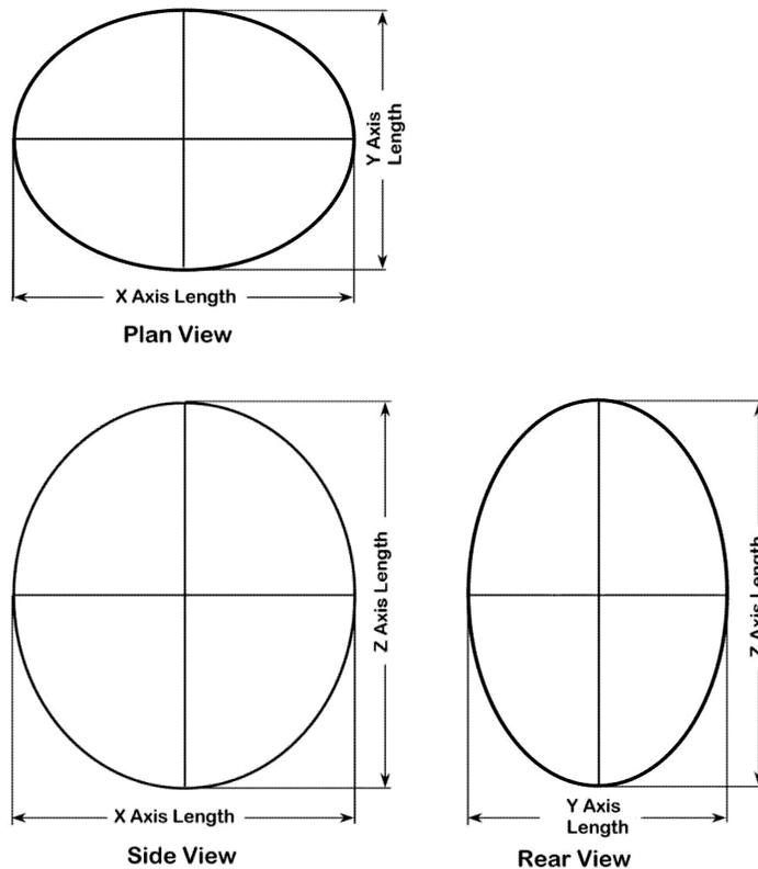
FIGURE B2—FIXED SEAT TANGENT CUTOFF EYELLIPSE FOR ONE EYE – TRUE VIEWS
