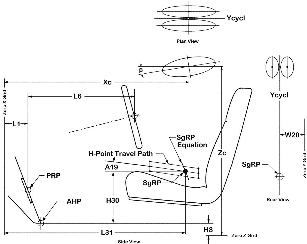
FIGURE 5—EYELLIPSE PACKAGE FACTORS, SIDE VIEW AXIS ANGLE, AND CENTROID LOCATION
