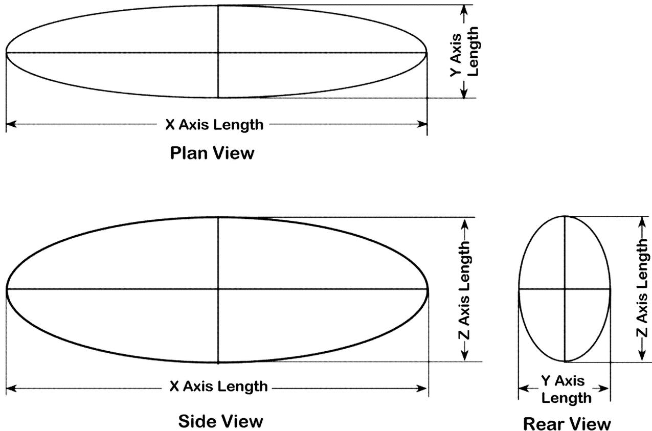
FIGURE 4—ADJUSTABLE SEAT TANGENT CUTOFF EYELIPSE FOR ONE EYE, THREE VIEWS
