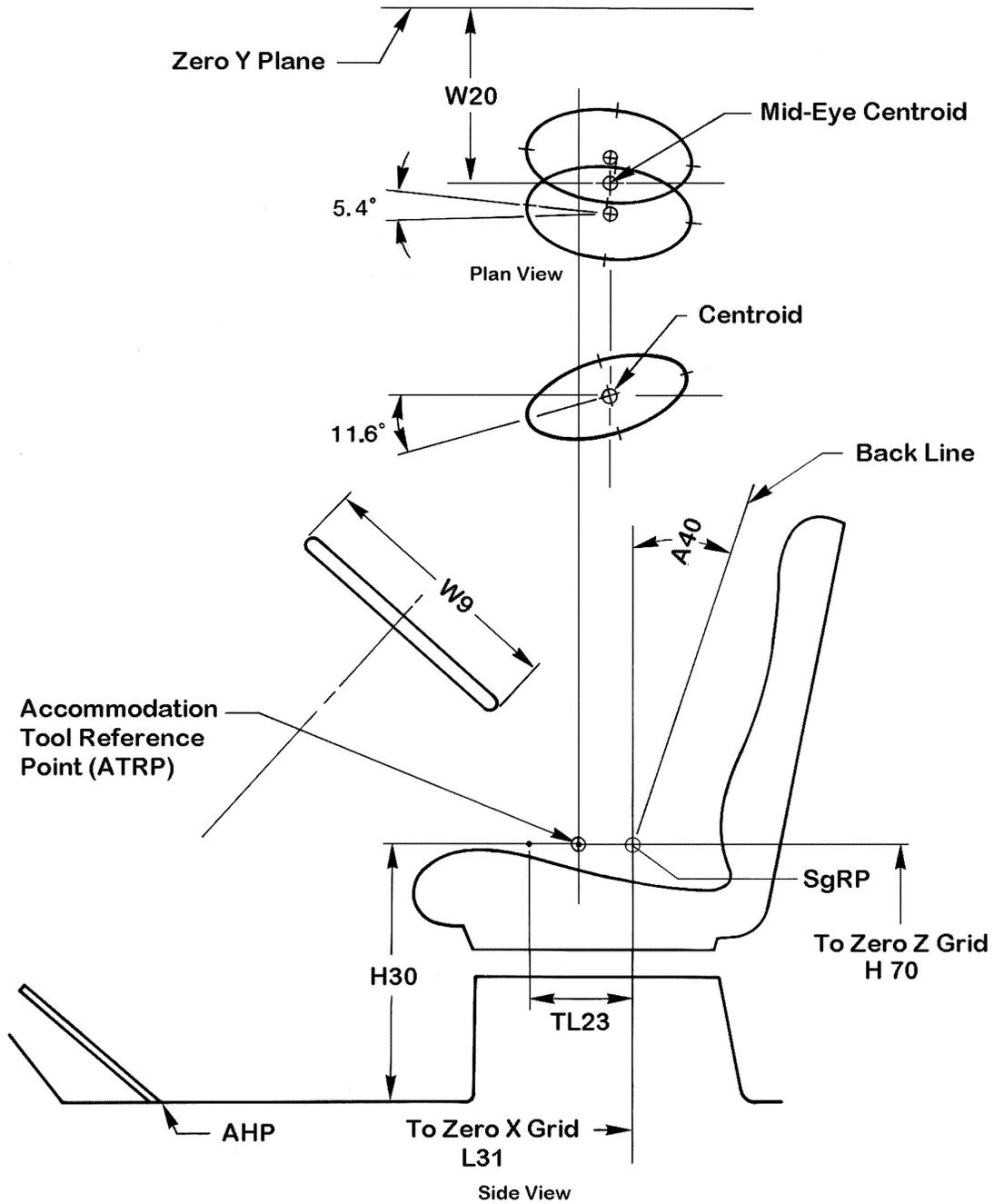
FIGURE E1—EYELLIPSE LOCATION IN CLASS B VEHICLES
